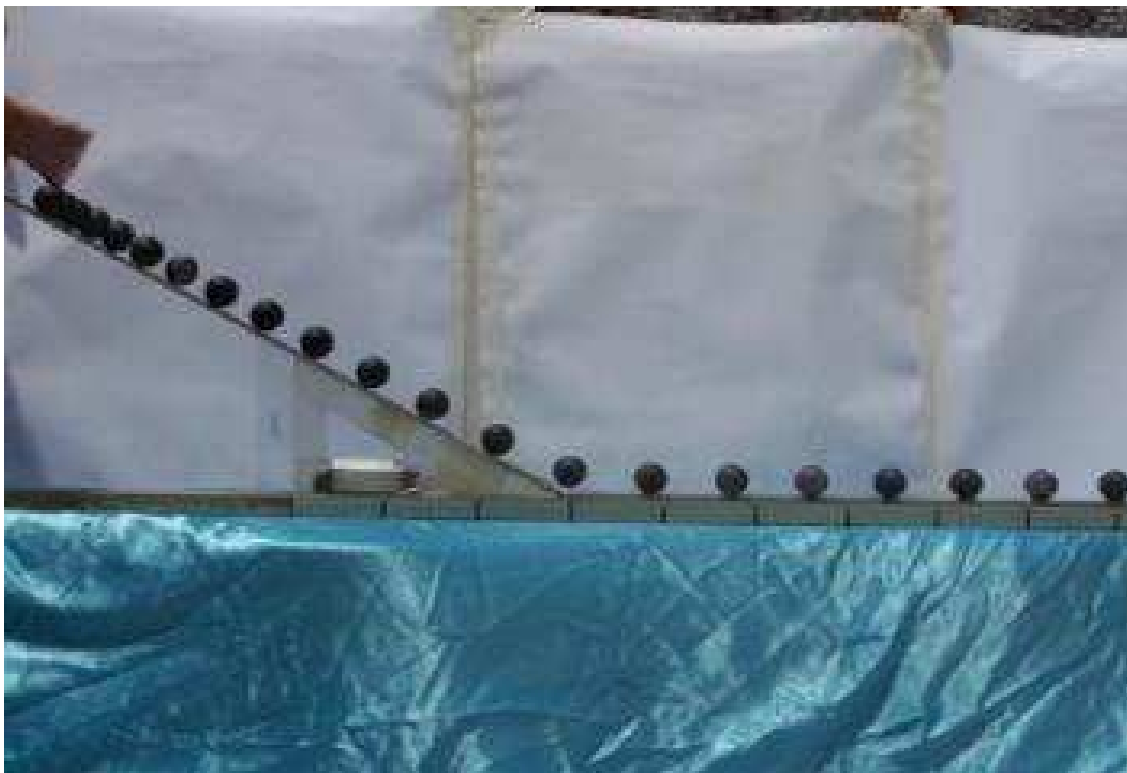
Figura 11: Esfera movendo-se inicialmente sobre uma canaleta inclinada com 30^\circ e depois na horizontal.
