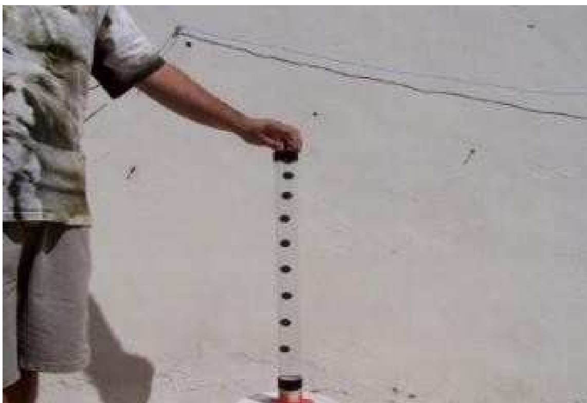
Figura 13: Esfera em queda dentro de um tubo de acrílico com 60 cm cheio d'água.
