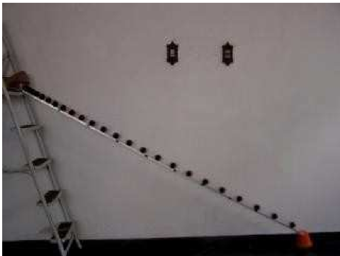
Figura 17: Esfera em movimento sobre uma canaleta inclinada com aceleração constante.
