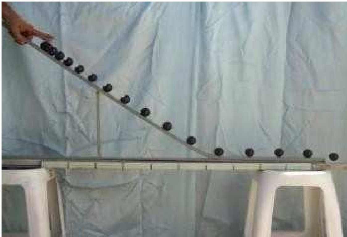
Figura 19: Esfera movendo-se inicialmente sobre uma canaleta inclinada e depois na horizontal.
