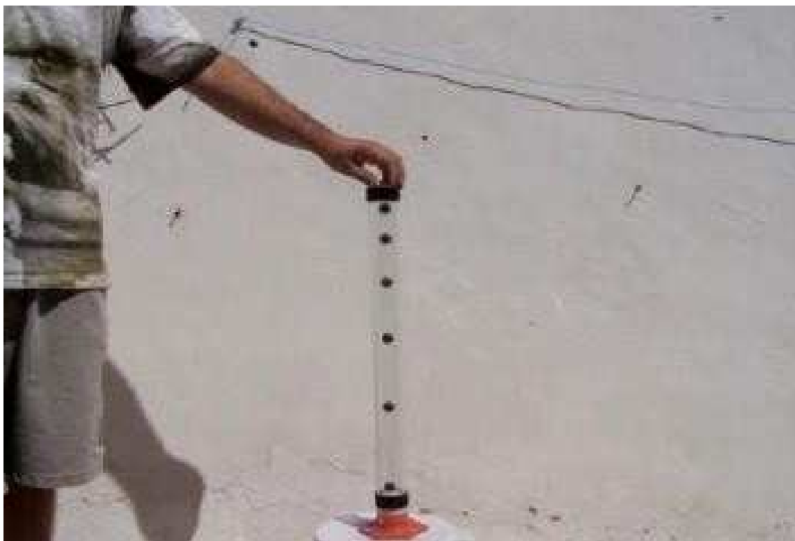
Figura 12: Esfera em queda livre dentro de um tubo de acrílico com 60 cm.
