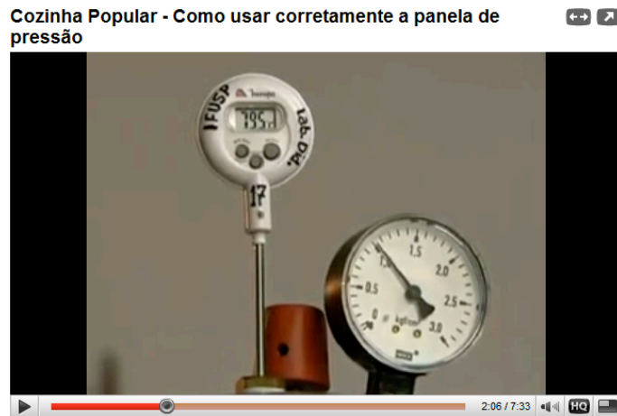
Figura 16. Termômetro e manômetro conectados à panela de pressão.
