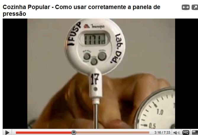
Figura 25. Temperatura no interior da panela de pressão com o pino pressionado para baixo durante a vaporização.
