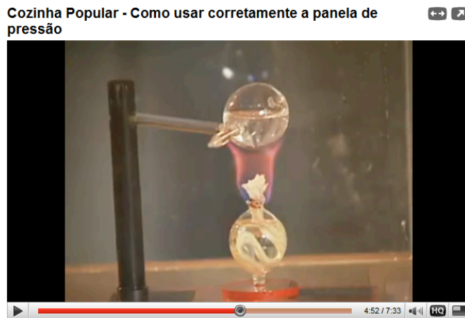
Figura 32. Água líquida à alta temperatura dentro do recipiente, pois, como a pressão é grande no interior do balão, a temperatura de mudança de fase aumenta muito.
