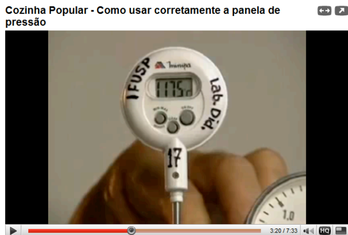
Figura 27. Temperatura no interior da panela de pressão com o pino pressionado para baixo durante a vaporização (aumento de temperatura para 117,5 °C).
