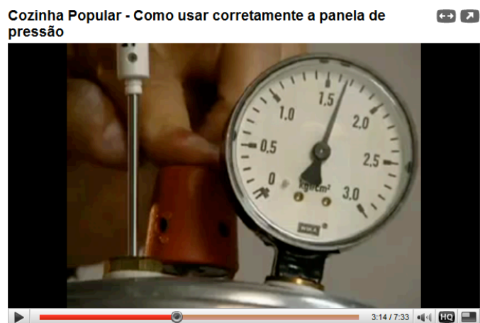
Figura 24. Professor da USP impedindo a realização de trabalho pelo gás ao apertar o pino para baixo e não deixar o vapor sair (pressão de aproximadamente 1,7 atm).
