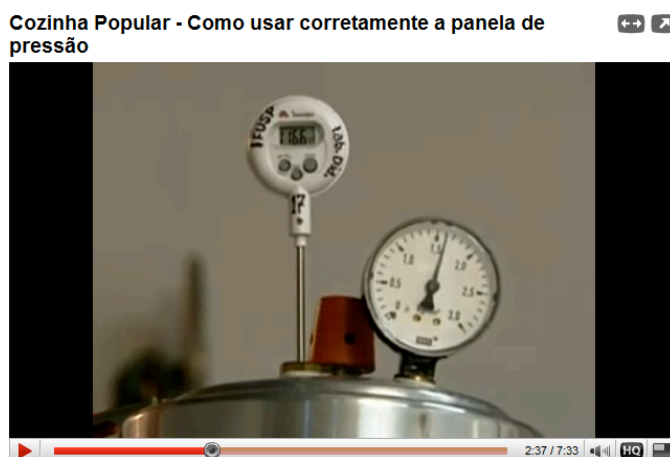
Figura 19. Indicações de temperatura e pressão no interior da panela de pressão durante a mudança de fase.
