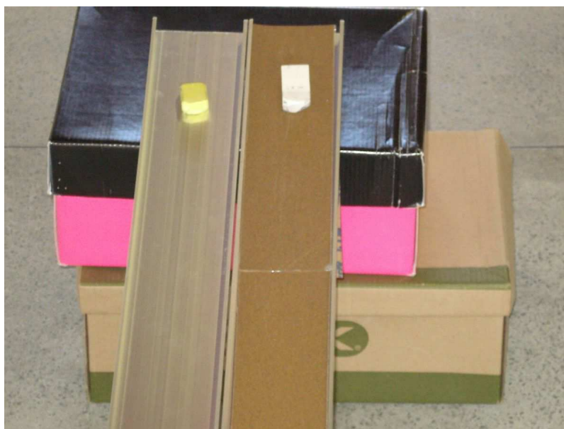
Figura 6: uma borracha sobre a rampa, e outra sobre a rampa coberta com uma lixa.
