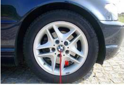
Figura 2.1: em vermelho vemos marcado o raio efetivo da roda, R . (adaptado de http://pt.wikipedia.org/wiki/Pneu )
