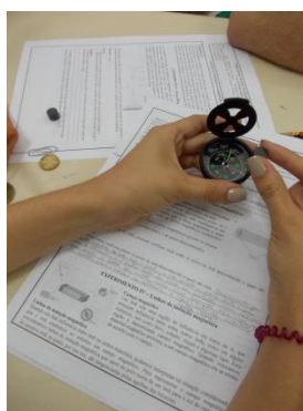
Foto 5: Aluna aproximando a bússola de um ímã a fim de identificar seus polos magnéticos norte e sul.
