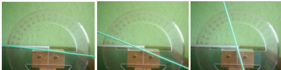
Figura 4.3. Expansão térmica da barra de alumínio, tornada visível pela rotação do canudinho fixado ao alfinete.
