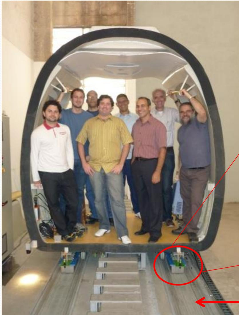
Supercondutores refrigerados com LN2 no interior de criostatos
